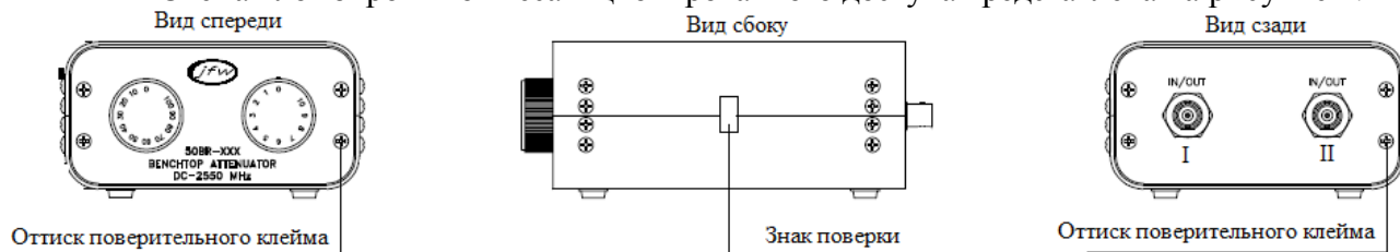
Рисунок 2 – Схема пломбировки аттенюаторов от несанкционированного доступа.
